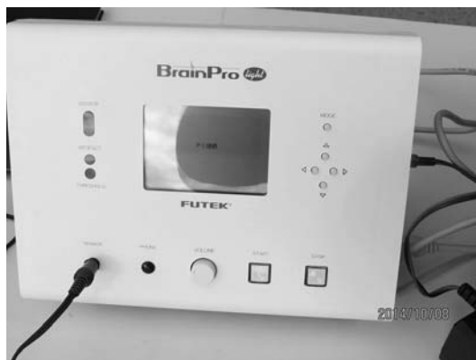
写真1 脳波計測計ブレイン・プロ・ライト FM-828T と設置状況
