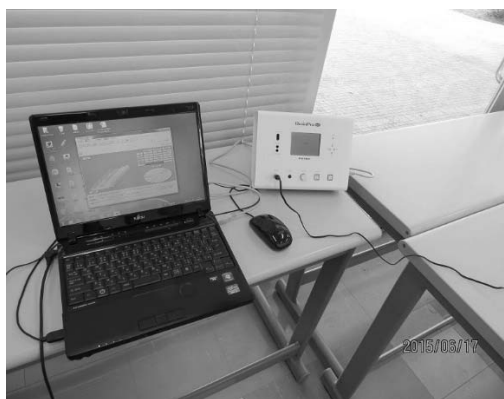
写真1 脳波計測計ブレイン・プロ・ライト FM-828T と設置状況
